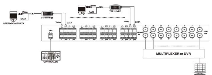
Пожалуйста, соблюдайте полярность при подключении видеосигнала. В противном случае изображение может быть нечётким или искажённым.
